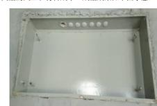
(3)在剪力墙、柱内安装线盒时,加强线盒模筋的焊接,提高线盒的贴墙率,以及线盒方正率,减少以后 修补量和剔凿量,同时要加强线盒标高的控制,做到每个线盒的标高均通过红外线水平仪定位。土建拆模 后及时清理线盒以及填塞线盒专用聚苯板(此方法比传统做法节省人工),以防墙面喷浆时污染线盒。
