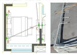
如左上图房间中 A、B、C 三个插座间的管线,根据图纸定位尺寸,我们就可以固化管路长度以及两端 管弯的长度,直接在后场制作成半成品,现场施工直接固定管线,可大大节约现场施工时间(右上图为制 成半成品的插座管)。
